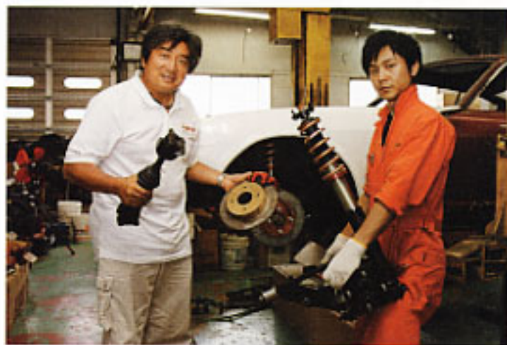
アラゴスタで特注したストラットユニットと、大径ディスクブレーキを装着することで最強マシンの足元をガッチリと固める。もちろん高剛性フレームの功とつた。
