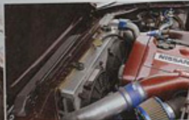
ボディカラーに合わせてペイントが施されたRB26DETは、ノーマルタービンのブーストアップによって驚きのパワーを発揮する。
